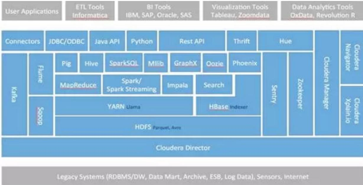
Cloudera的软件体系结构中包含了以下模块：系统部署和管理，数据存储，资源管理，处理引擎，安全，数据管理，工具库以及访问接口。一些关键组件的角色信息：
